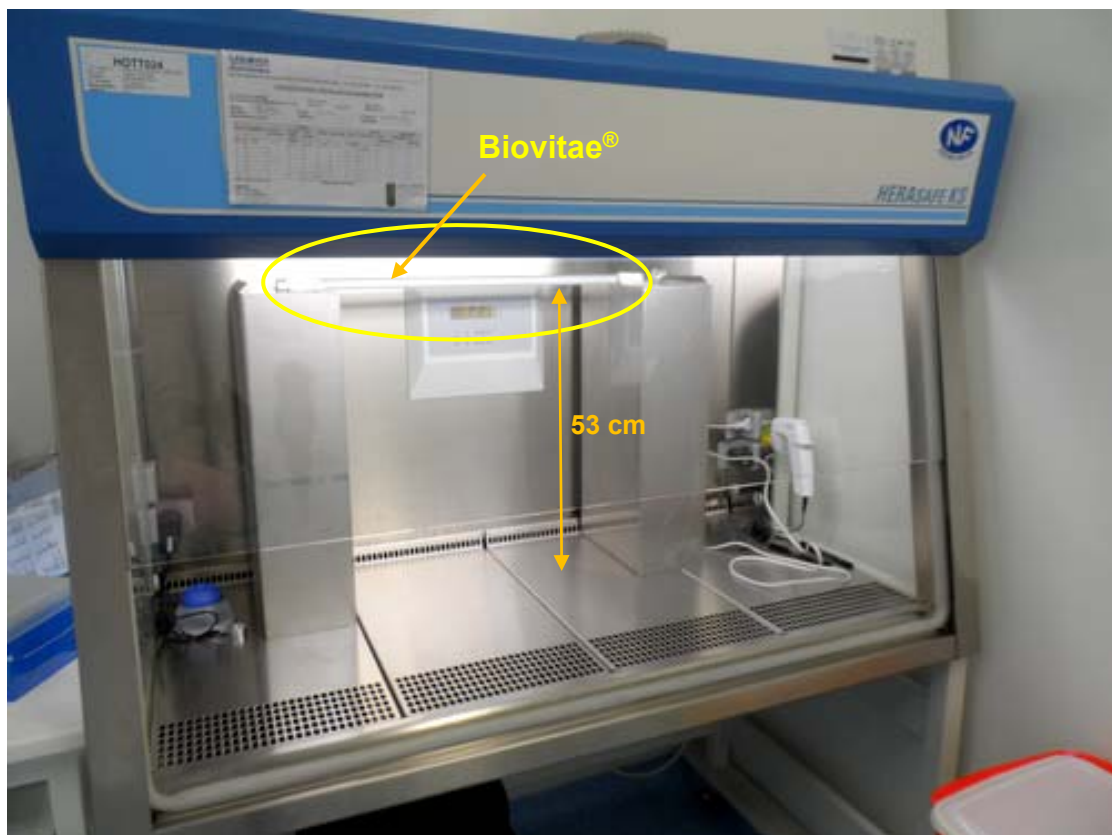
Fig 2 : Lampe Biovitae installée dans un PSM II du laboratoire P3 avec une hauteur de 53 cm du plan de travail où seront disposés les échantillons de virus.
